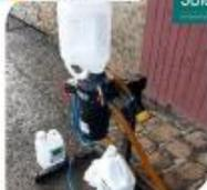
**Atelier « EasyConnect »** : système de transfert fermé pour une incorporation zéro contact des produits, du bidon vers la cuve
