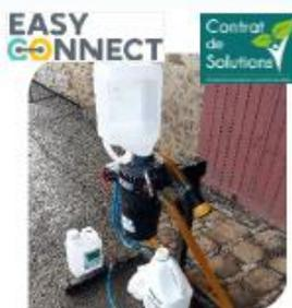
**Atelier « EasyConnect »** : système de transfert fermé pour une incorporation zéro contact des produits, du bidon vers la cuve
