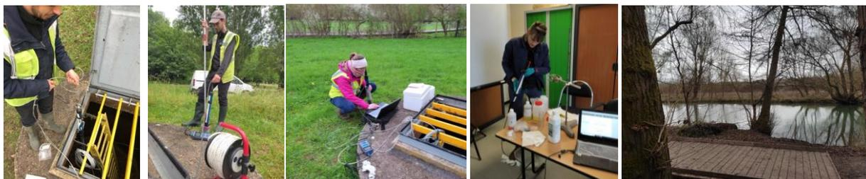
Placement de la sonde in-situ au sein du puits (03/02) ; Prélèvements à la perche et mesures terrain (06/12), vérification et extraction des mesures (04/03) ; Calibration de la sonde au bureau (01/02) ; Vue de l'Yerres située à 100 m du puits (01/02).
